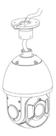
Fixez la caméra au plafond et serrez les 4 vis complètement
